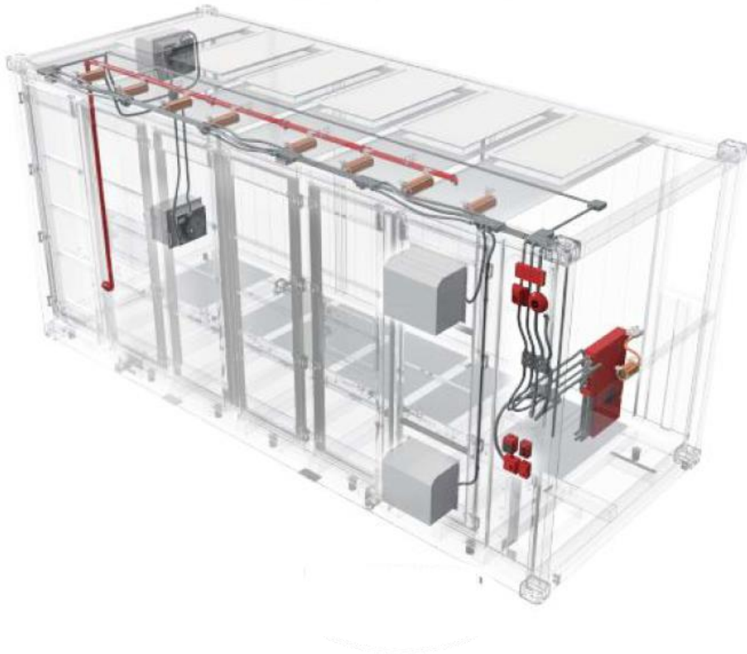
Kuva 5: Yleiskuvaus palonilmaisu- ja torjuntajärjestelmästä.
